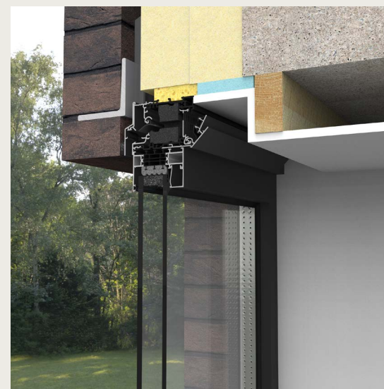
Volledig achter slag - binnen en buiten
